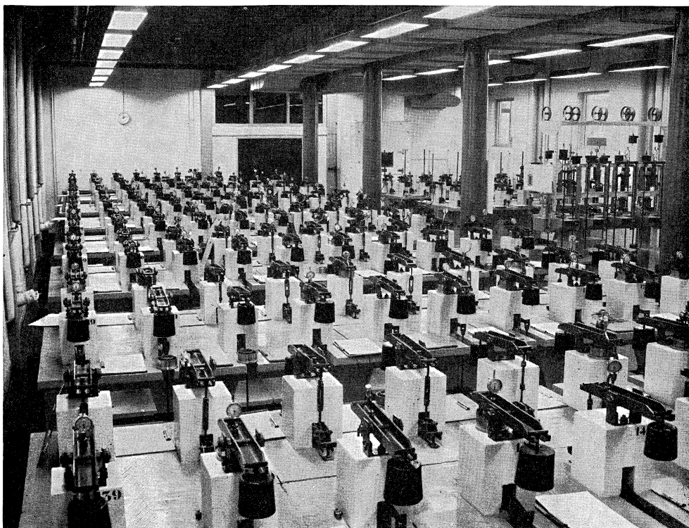
Laboratoriumruimte met constante temperatuur waarin opgesteld de samendrukkings- en cel-apparaten
